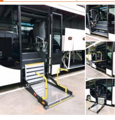
Les élévateurs à cassette **DH-CH102.03** sont généralement **intégrés dans les marches de(s) la porte(s)** du milieu des bus et cars M3.
