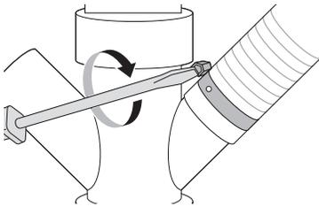
**Raccordement à un broyeur ou à un té de vidange avec coupure antirefoulement.**
