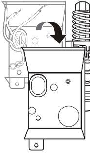
**5** Insérez un serre-câbles **2** dans la boîte de jonction en le faisant passer par le trou. Serrez l'écrou à œil **3** pour le fixer.
